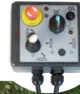
Steuergerät zur Positionierung in der Kabine
