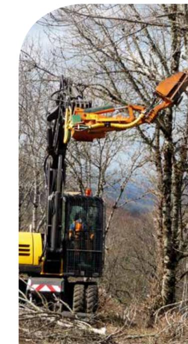
Für alle schwierigen Arbeiten mit seitlich versetztem Sägeblatt oder Zurückschneiden bei maximaler Höhe des Löffelstiels. Besonders effektiv für zugewachsene Straßenränder dank der Positionierungsgelenke der Astsäge rechts oder links für größere Sicherheit. Ein sicherer Wert für Unternehmer und Gemeinden.
