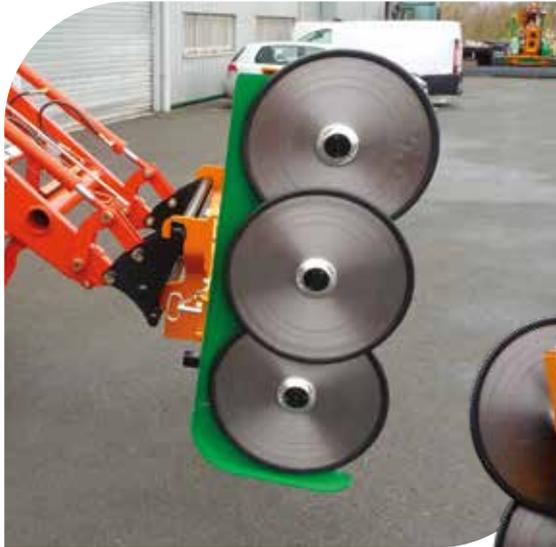
▲ **BARRA DE CORTE** equipada con 3 a 4 cuchillas de sierra Ø500mm
