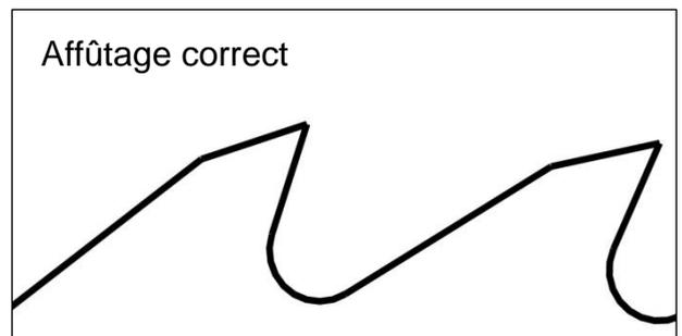
Les lames stellitees sont livrées pré-affûtées, il est donc recommandé de les faire travailler moins longtemps lors de la première mise en service, avant reprofilage complet et affûtage en passes légères. Les criques en fond de denture proviennent souvent d'une opération de profilage incomplète, la meule d'affûtage n'ayant pas éliminé les traces de fatigue du métal en fond de dent.
