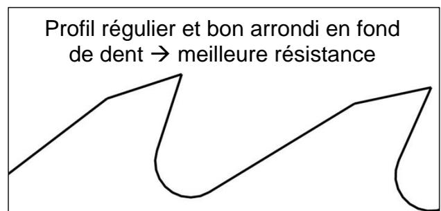
L'affûtage ne devra créer aucune rupture de profil, creux, bosses ou facettes qui ont pour objet d'affaiblir la résistance de la lame, donc des risques d'amorces de criques. Il faut donc veiller spécialement au bon arrondi en fond de dent, et à sa régularité. L'affûtage sera exécuté avec une meule appropriée en plusieurs passes modérées pour ne pas brûler l'acier.
