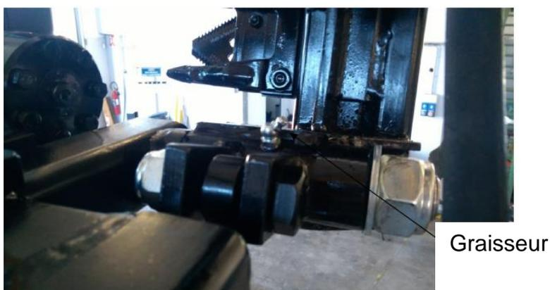
Un graisseur est présent sur le joint de rotation de la barre de coupe du haut.
