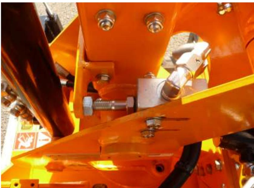
Pour pouvoir utiliser la rotation du pivot il faut que le vérin du bras 1 soit sorti au maximum, ainsi la rotation sera autorisée ce qui permettra de mettre le pivot à  $90^{\circ}$  en mode travail soit de d'utiliser l'amplitude complète du bras 1 pour se mettre en position transport.
