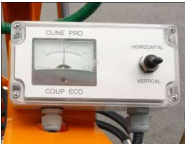
Ce dispositif se compose d'un capteur électronique d'inclinaison fixé sur l'outil de coupe et d'un boîtier afficheur fixé à proximité des leviers de commande.
