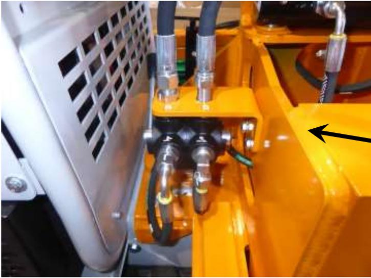
Vanne 6 voies permettant l'action du bras 1 ou l'orientation pivot.
