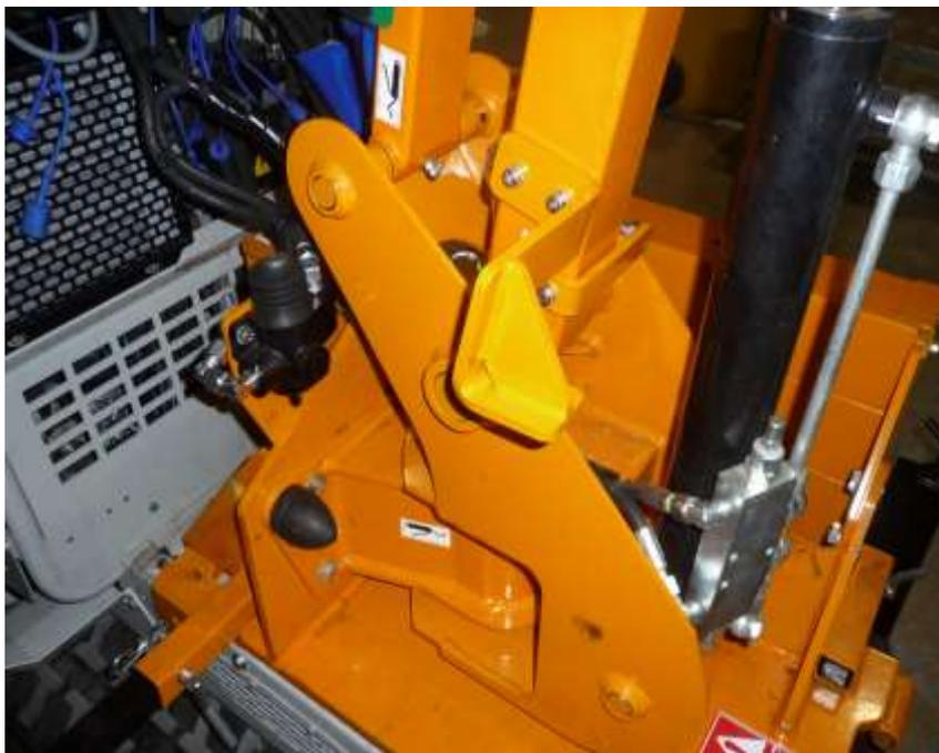
Pour garantir la stabilité du porteur et du taille-haies, un capteur de fin de course a été positionné sur le châssis pour limiter l'amplitude du bras 1 éviter un basculement du porteur.
