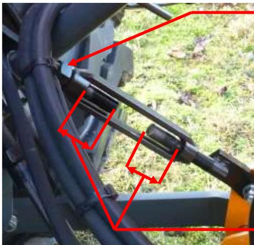
Contre écrou de blocage en position
